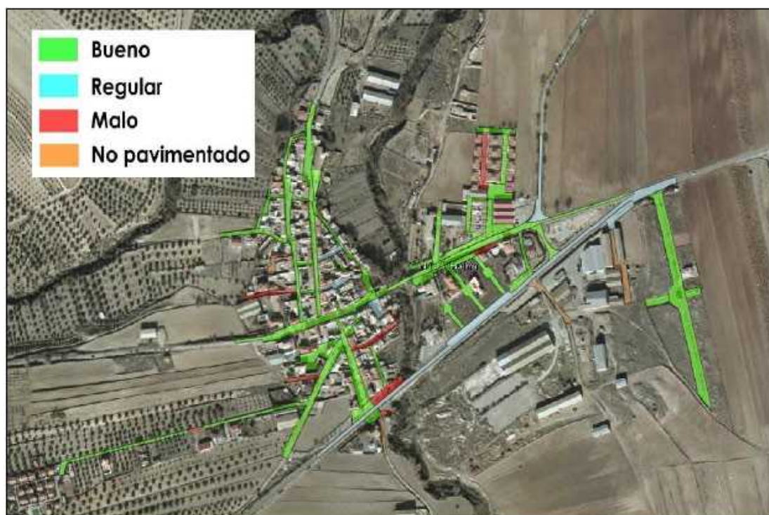
Estado de conservación del viario urbano del núcleo de Ventas de Huelma
