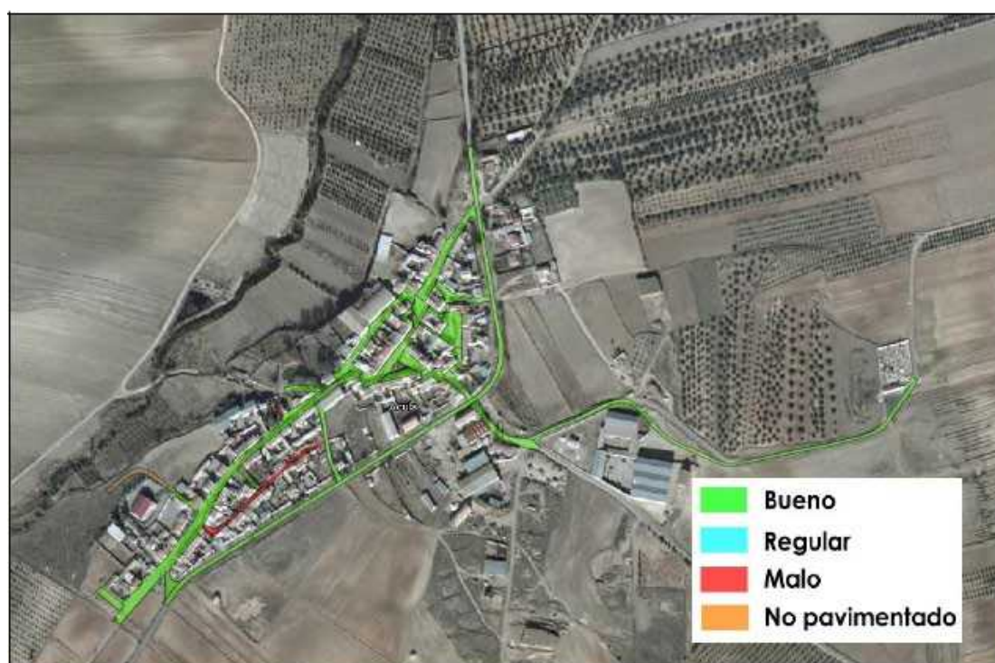
Estado de conservación del viario urbano del núcleo de Ácula
